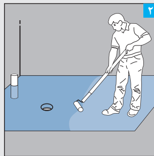
پس از خشک شدن کامل لایه اول (تقریباً پس از ۶ ساعت) لایه دوم عایق را عمود بر جهت اول اعمال نمایید.
