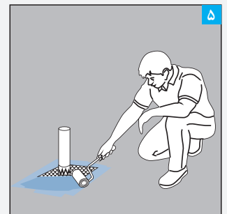
۵ مجدداً یک لایه عایق آبی را بر روی کف به نحوی اجرا نمایید که لایه الیاف کاملاً پوشش داده شود.
