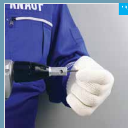
برای نصب پنل‌ها از پیچ مخصوص و دستگاه پیچ زن استفاده می شود
